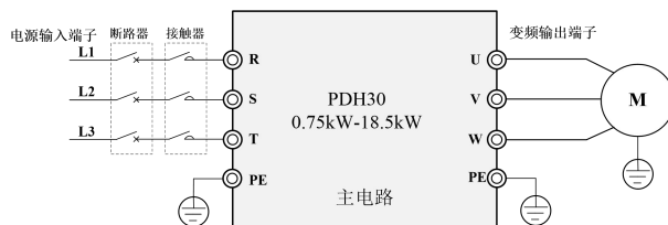
图 2-5-1 0.75kW-18.5kW 主端子示意图
