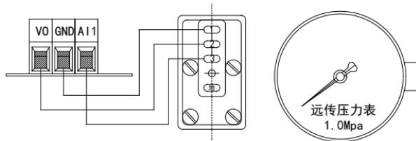
(2) **压力变送器:** 工作电压 10~30V, 输出 4~20mA, 接线方式如下图所示:
