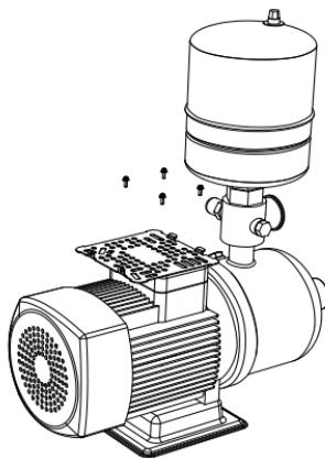
第三步：将变频器固定在铁板上
