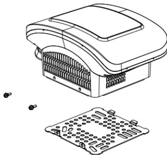
第二步：将拆下的底板安装在电机上
