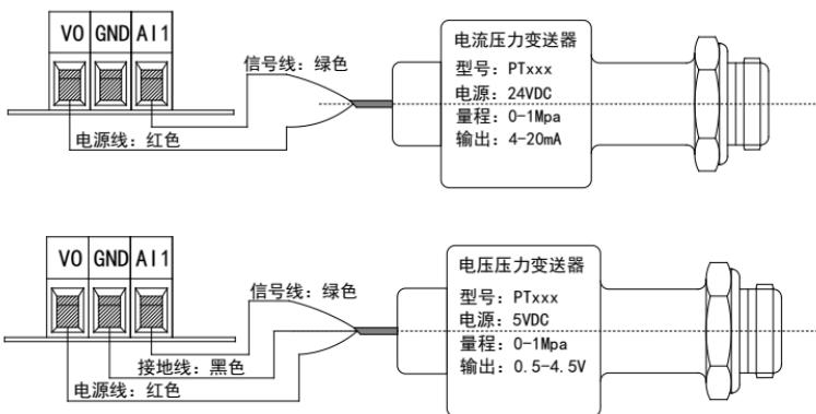
注: 型号为 PDM30-2SXXXLN 的产品出厂时配有专用传感器(红色线接+VO, 黑色线接 AI); 各类型传感器接线方法及相应参数设置请查看附录
